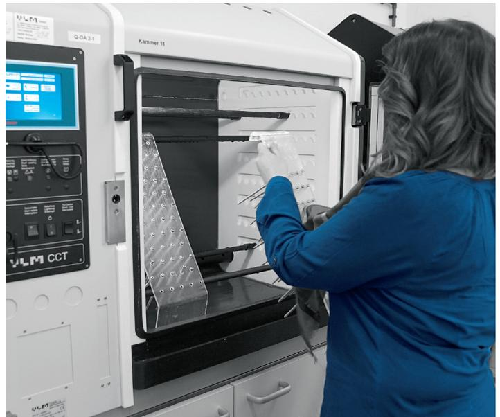
Um Korrosionsbedingungen so realitätsnah wie möglich darzustellen, drängen vermehrt Klimawechseltests in den Markt. Durch zyklische Korrosions- oder Klimawechselprüfungen, wie nach VDA 233-122 werden reproduzierbare und praxisnahe Korrosionsbilder erzeugt.
