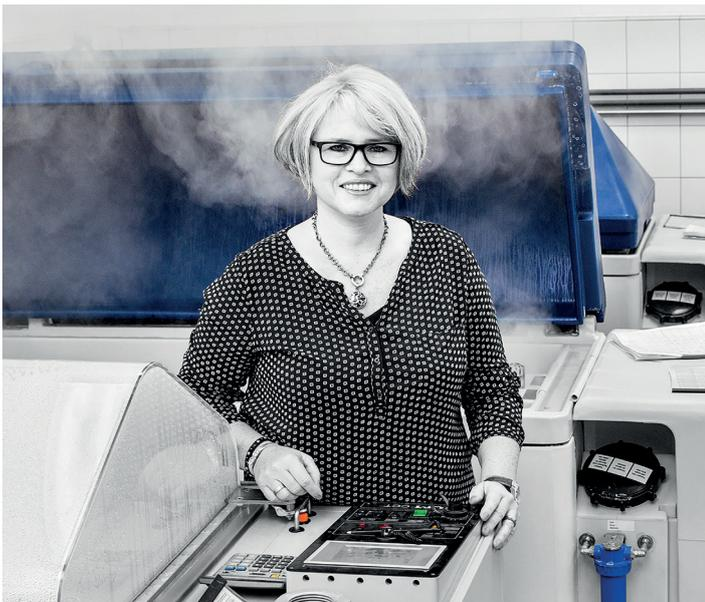
Die Salzsprühnebelprüfung ist der am häufigsten eingesetzte Test zur beschleunigten Korrosionsprüfung. Testproben werden konstant mit einer 5%-igen Natriumchlorid-Lösung besprüht.
