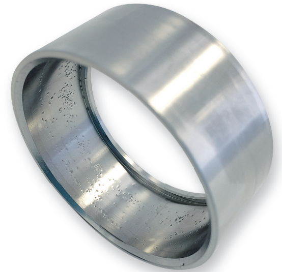
Beispielhafter Partikelverlust während der Extraktion bei einer Analyse der Technischen Sauberkeit.
